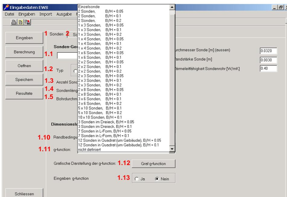
**Abb. 3.8: Blatt "Sonden", Auswahl der Sondenanordnung unter 1.11.**
