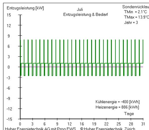
**Abb. 3.42: Taktendes Leistungsprofil, erzeugt mit dem Blatt „Lastprofil“.**
