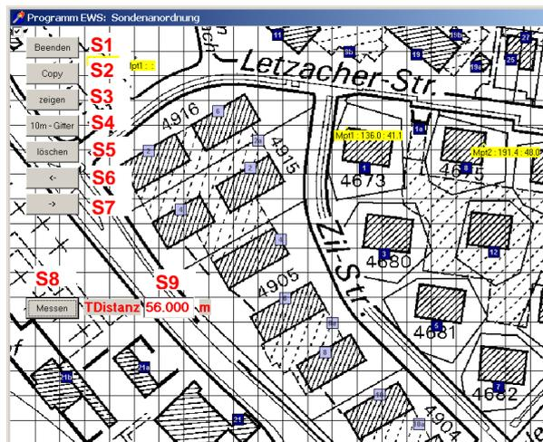
Abb. 3.15: **3. Schritt:** Gitternetz skalieren: Auf der Karte 2 markante Punkte auswählen, Distanz bestimmen und in Feld **S9** eingeben. Anschliessend beide Messpunkte mit Maus auf Karte anwählen und durch Klicken irgendwo auf Blatt abschliessen.
