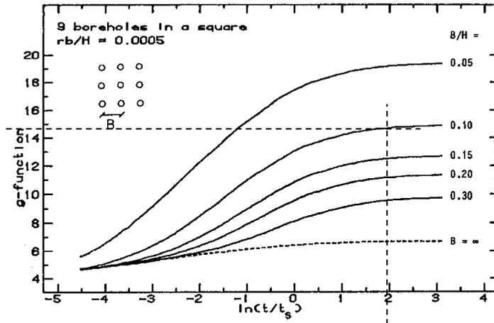
Abb. 7.1: Beispiel einer publizierten g-function (aus [3]) und Auslesen des Funktionswertes an der Stützstelle  $\ln(t/t_s) = 2$ .
