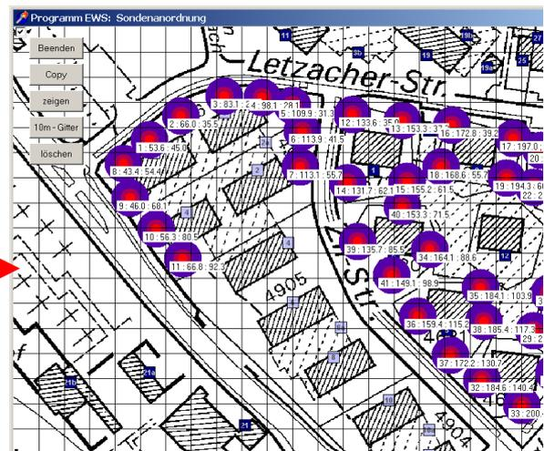
Abb. 3.16: **4. Schritt:** Kartengrösse mit Taste **S6** und **S7** auf die gewünschte Grösse skalieren und Sonden gemäss Beschreibung Kapitel 3.3.2 eingeben. **Achtung:** Sobald Erdwärmesonden angewählt sind, kann die Karte nicht mehr angepasst werden.
