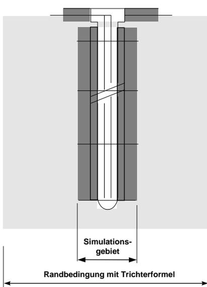
Für die Simulation der Erdreichtemperaturen im Sondennahbereich (1.5 m - 3 m) soll das Crank-Nicholson-Verfahren angewendet werden.
