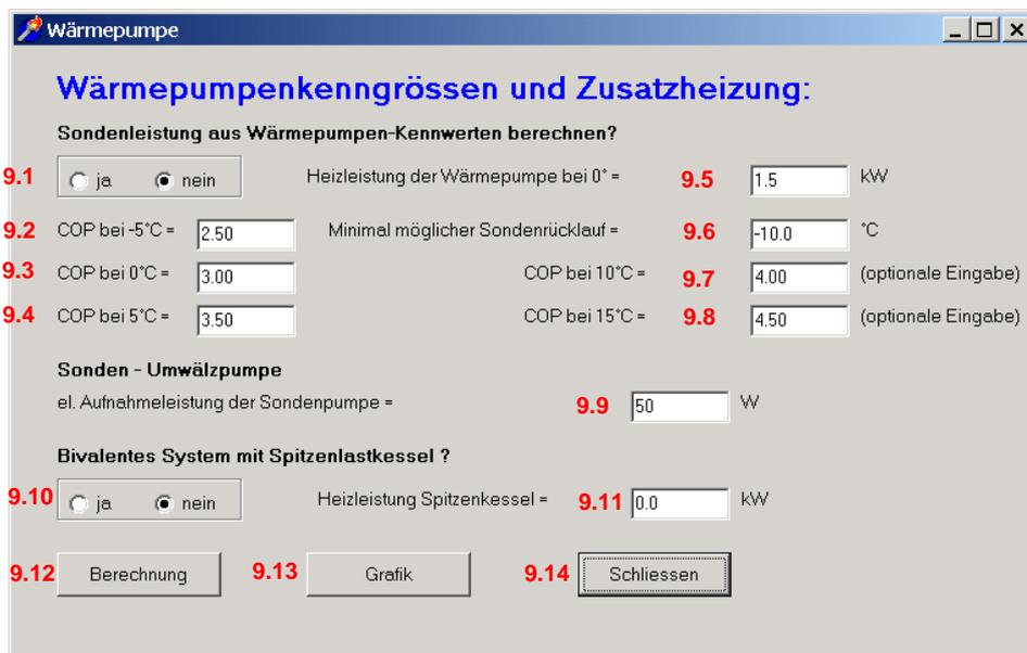
Abb. 3.80: Eingabemaske "Wärmepumpenkenngrößen und Zusatzheizung".
