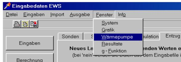
Abb. 3.79: Aufrufen der Eingabemaske für Angaben über die Wärmepumpe
