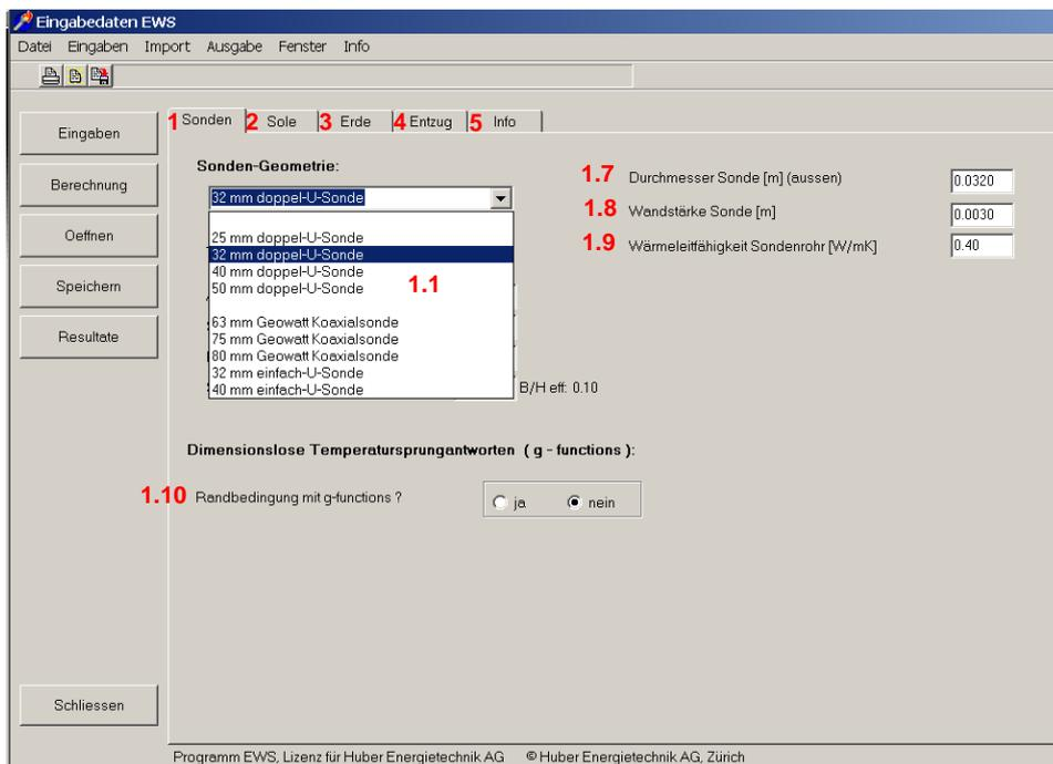
**Abb. 3.3:** Blatt "Sonden", Auswahl des Sondentyps unter Feld 1.1.
