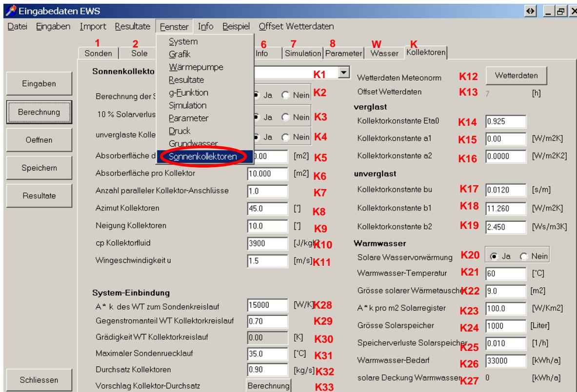
Abb. 3.69: Blatt „Sonnenkollektoren“ zur Berechnung der solaren Sondenregeneration
