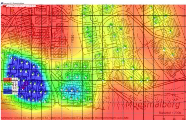
Bohrtiefe der Erdwärmesonden = 250.0 m
