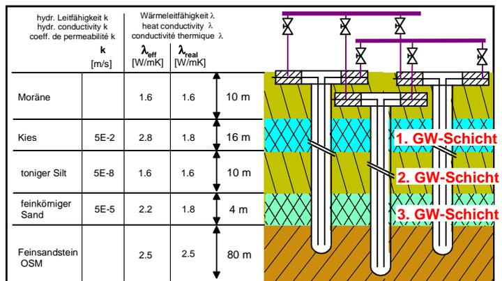
**W23-W25** Die Jahreszeitschwankungen der Erdoberfläche können optional zugeschaltet werden. Dies kann bei starker Grundwasserströmung und bei un tiefen Sonden und Energiepfählen Sinn machen. In diesem Fall wird die Erdoberflächtemperatur in Abhängigkeit der Tiefe  $z$  wie folgt korrigiert:
