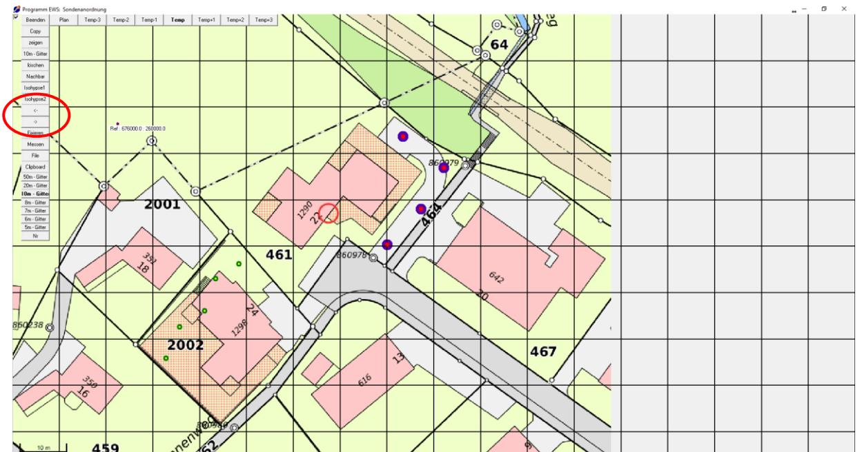
Abb. 3.20: Skalierung der Bildschirm-Darstellung mit den Skalierungs-Buttons (Pfeil-Tasten).
