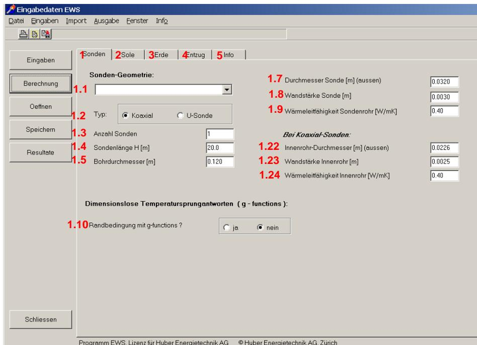
Abb. 3.5: Blatt "Sonden", Auswahl der Koaxialsonde in Feld 1.2.
