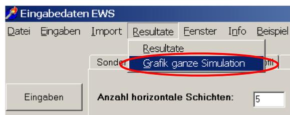
Darauf erscheint der Verlauf über die ganze Simulationsperiode. Dargestellt wird, je nach Auswahl, die monatliche Maximaltemperatur (rot), Minimaltemperatur (blau) oder Durchschnittstemperatur (grün) der Sonden-Rücklauf-temperatur (TSink = Sonden-Eintrittstemperatur), sowie die Soletemperatur TBrine (pink, Durchschnittstemperatur von Quelltemperatur und Sondenrücklauf-temperatur  $T_{Brine} = (T_{Sink} + T_{Source})/2$ ):
