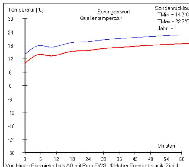
**Abb. 3.64: Beispiel einer Sprungantwort einer Sonde in der ersten Stunde.**
