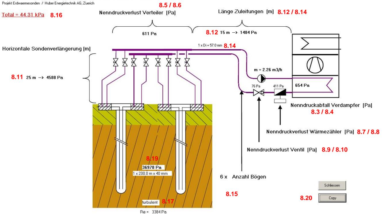
Abb. 3.77: Darstellung der Resultate im Sondenkreislauf
