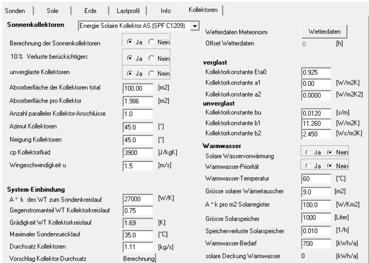
Abb. 3.58: Definition der Anlage nach der Sanierung (z.B. mit 100 m<sup>2</sup> unverglasten Sonnenkollektoren)
