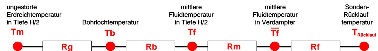
Abb. 6.9: Thermische Widerstände in einer Erdwärmesonde
