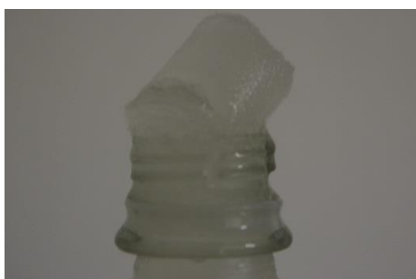
Abbildung 13: Gefrierversuch mit 12 % Vol.-Mischung: es ist eine kleine Volumenzunahme feststellbar, es entsteht aber kein fester Eisblock, sondern überflüssiges Gel tritt als Pfropfen und Flüssigkeit aus einer PET-Flasche.
