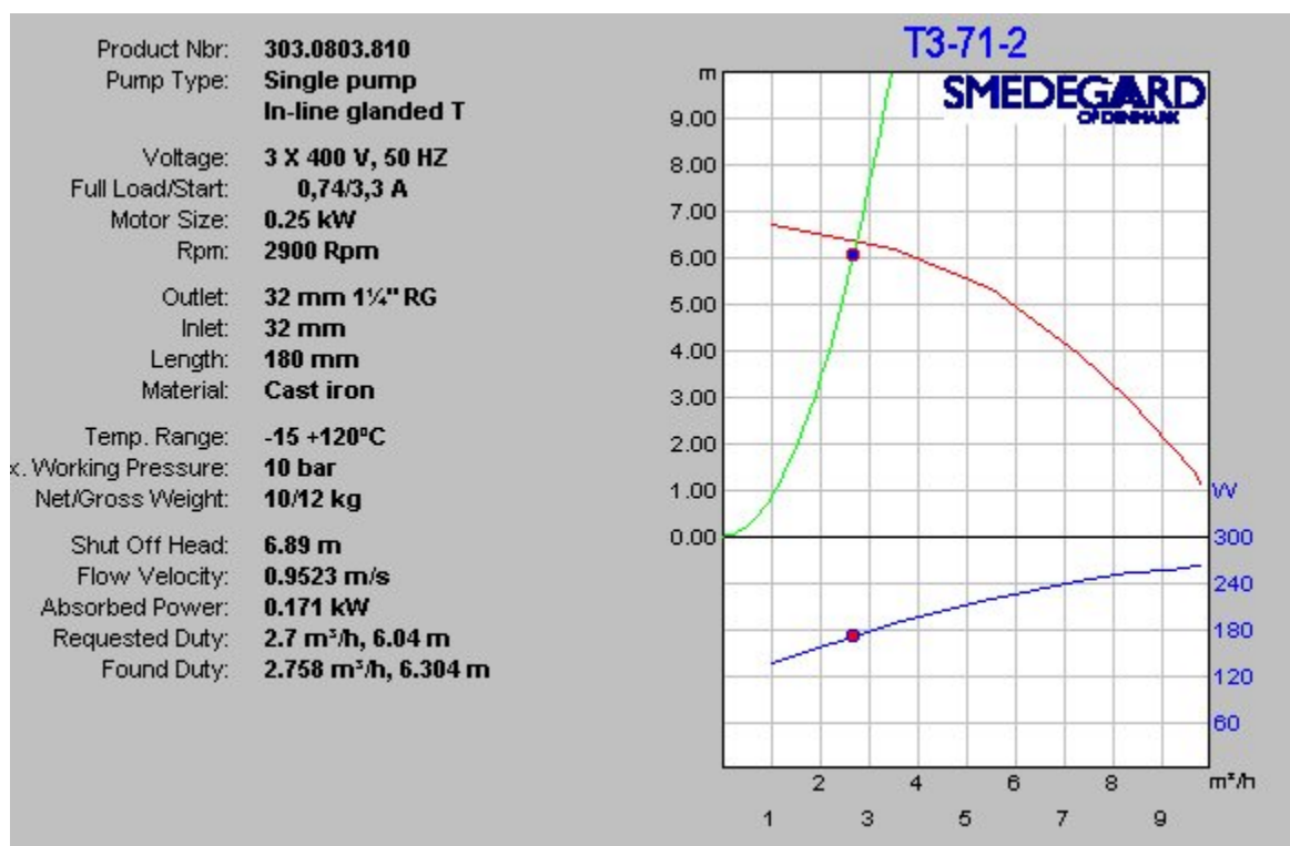
Abb 4-1: Betriebspunkt der Sondenpumpe der Anlage Wehrli im Nennbetrieb
